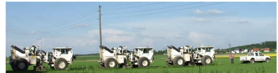
Vibratoren bei der Aussendung seismischer Wellen
