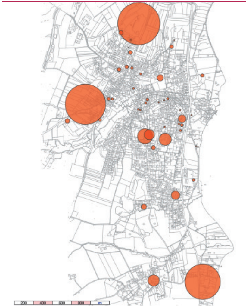
Abb. 2: Wärmebedarf der Einzelobjekte in Utting (proportional zum Durchmesser der Kreise) ■
