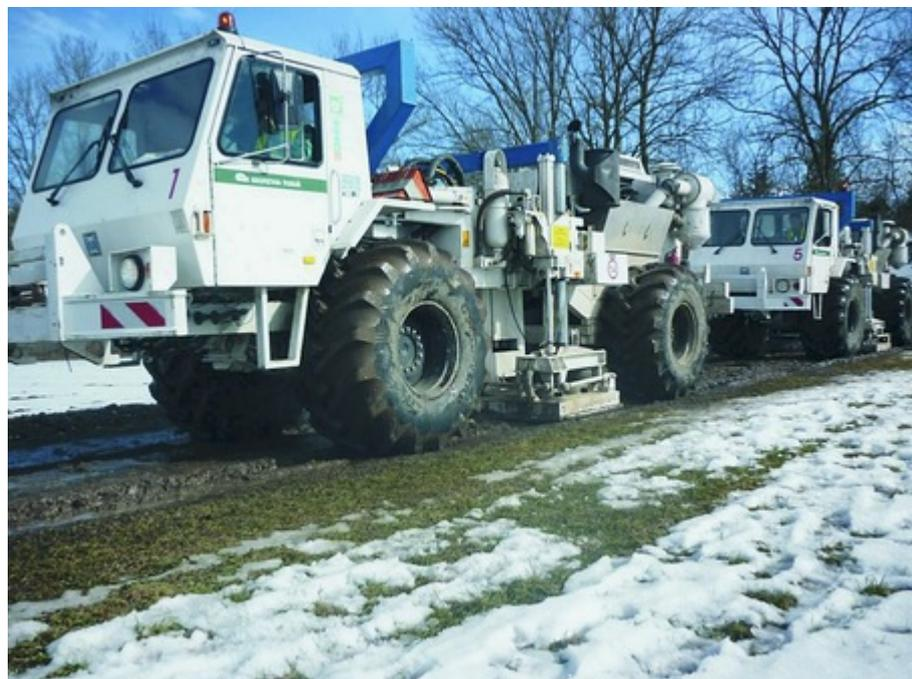
Diese drei Spezialfahrzeuge erzeugen die Schallwellen im Untergrund, die von 3500 Messpunkten aufgefangen werden. Nach der Auswertung ergibt sich so ein dreidimensionales Bild des Untergrundes in 3000 bis 4000 Metern Tiefe. Die Schwingungen werden durch die schweren Platten in der Fahrzeugmitte in den Boden übertragen. Fotos: wt
